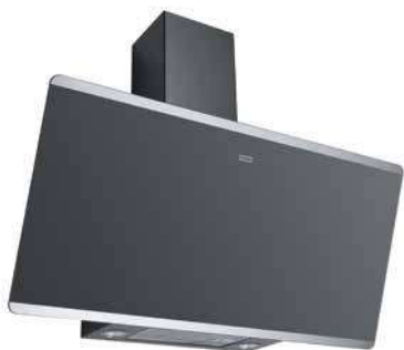
FRANKE - 470070 Hotte décorative EVO PLUS - 4 vitesses - 720 m 3 /h - Commandes sensibles - Aspiration périphérique - 2 niveaux de filtration - Eclairage LED - Energie A - Finition verre noir - Dim. (LxHxP) : L 89,8 x H 38,2 x P 37,8 cm.
